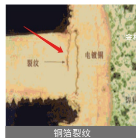
铜箔裂纹 Foil Crack
